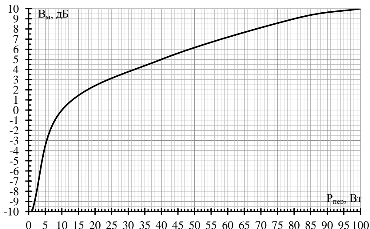
Рис. 3.1. Зависимость мощности радиостанции от поправочного коэффициента B_m
